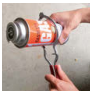
▲道具で穴を開けている様子
