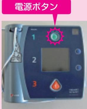
②音声メッセージとランプの点灯で指示してくれるので、指示に従ってパッドを張ってください。
