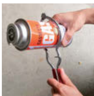
▲道具で穴を開けている様子
