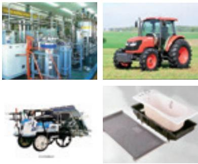
ここ二本松市では2000年より操業し、今年18年目を迎えます。福島工場では「RIM工法」と呼ばれる短時間で大型・複雑形状の成形が可能な工法を活用し、主に建設機械/農業機械/住宅設備機器/産業機械/トラック等、幅広い分野で国内外に採用され、設計から一環生産を行なっています。
