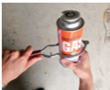
▲専用の道具で穴を開けている様子
