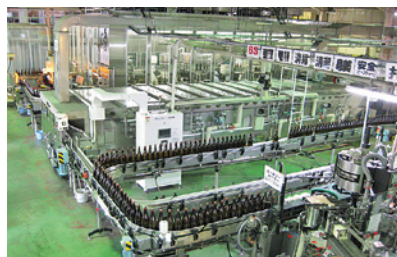
パストライザーによる瓶詰めライン
