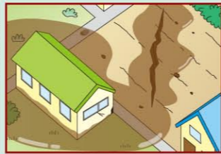
液状化現象の被害の例
