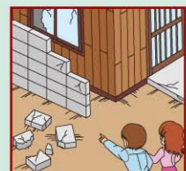
ブロック塀転倒の例
