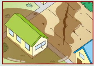
液状化現象の被害の例
