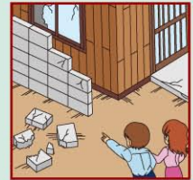
ブロック塀転倒の例
